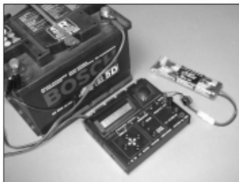
Anschluß des Gerätes an die Autobatterie und eines Flug- bzw. Fahrakkus an den Lader
